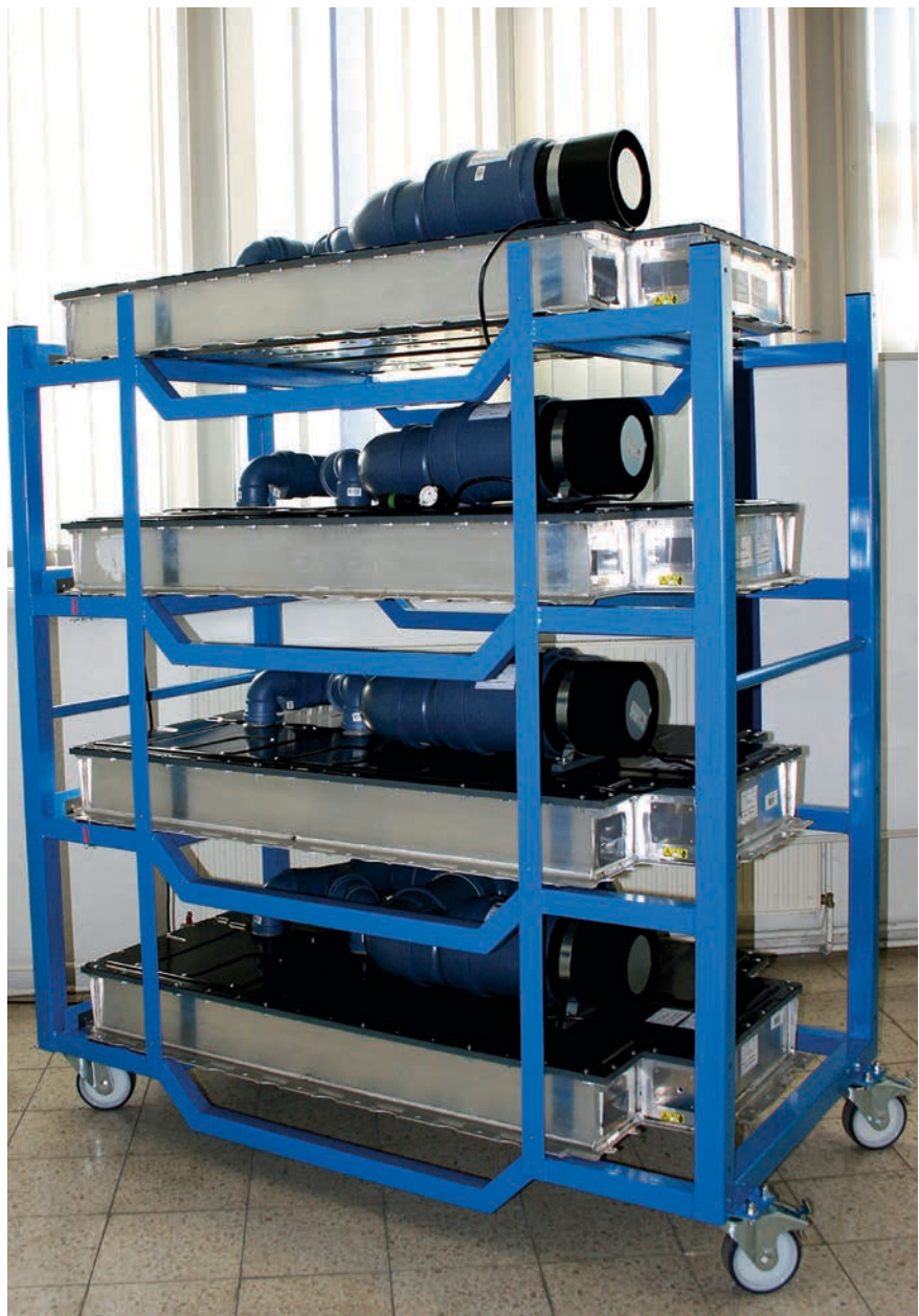
BILD 3 Gebrauchte Elektrofahrzeug-Hochvoltspeicher von vier Fahrzeugen als stationärer Gesamtspeicher in Rackbauweise (© EVA Fahrzeugtechnik)
