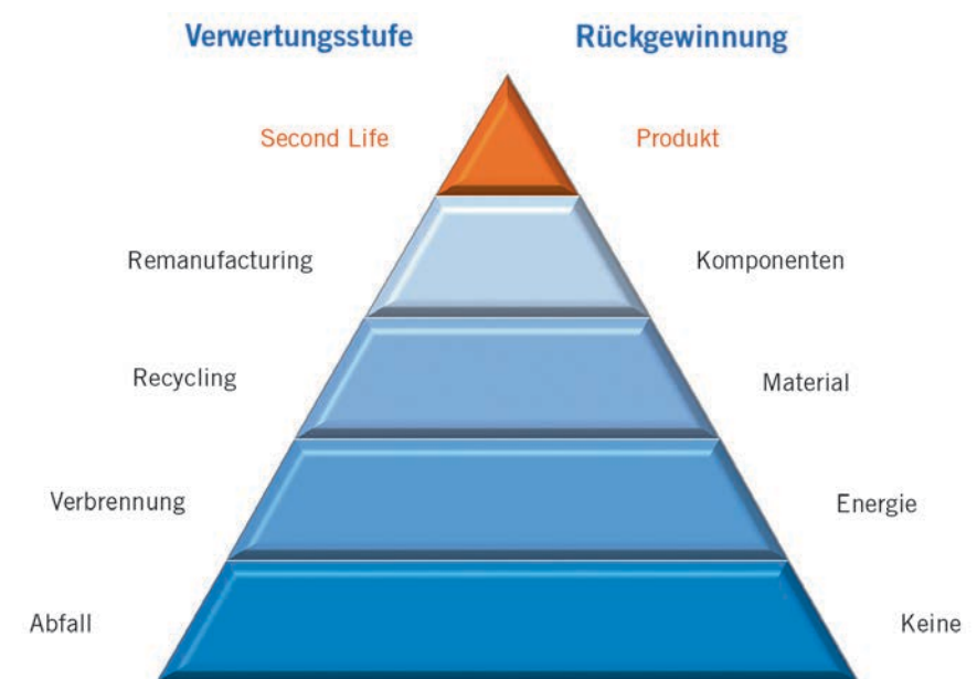
BILD 1 Darstellung der Wiederverwertungs- und Rückgewinnungspyramide mit unterschiedlichen Verwertungsstufen und jeweiliger Rückgewinnung (© EVA Fahrzeugtechnik nach [1])
